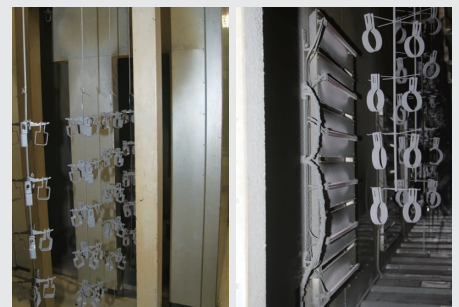
ハイブリッド乾燥炉出入口 1箇所につき6本のヒーター
