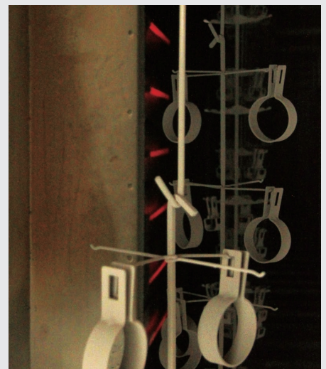
炉内前半部は中赤外線による焼き付け乾燥
